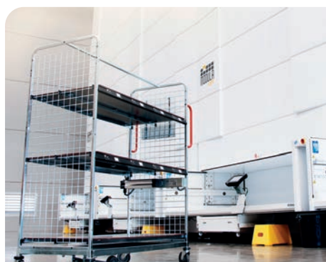
Vychystávací vozík se systémem Put-to-Light
